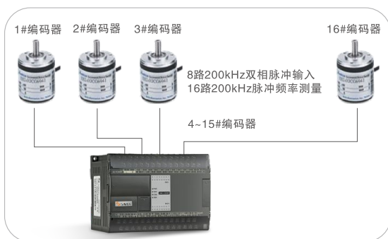
SAVCH PLC 带16个编码器
